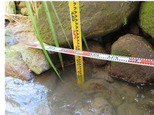
写真2.9-4 【B橋】背面土の流出状況の計測事例(近景)
