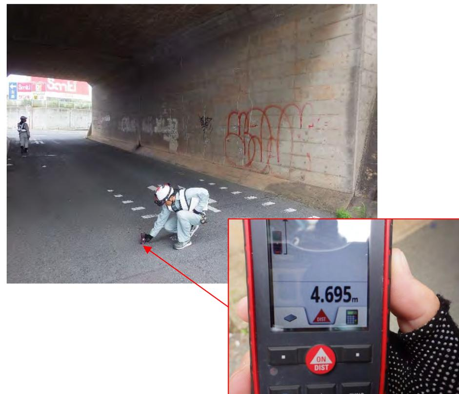
写真2.6-2 デジタル測距による形状確認の事例<sup>15</sup>
