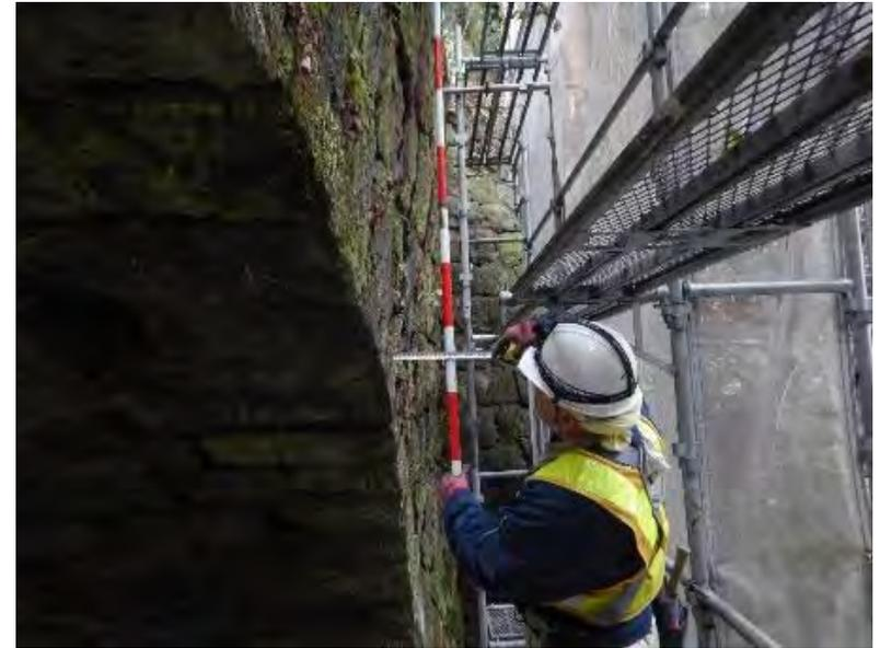
写真2.36-1 はらみ出しの計測状況の事例①
