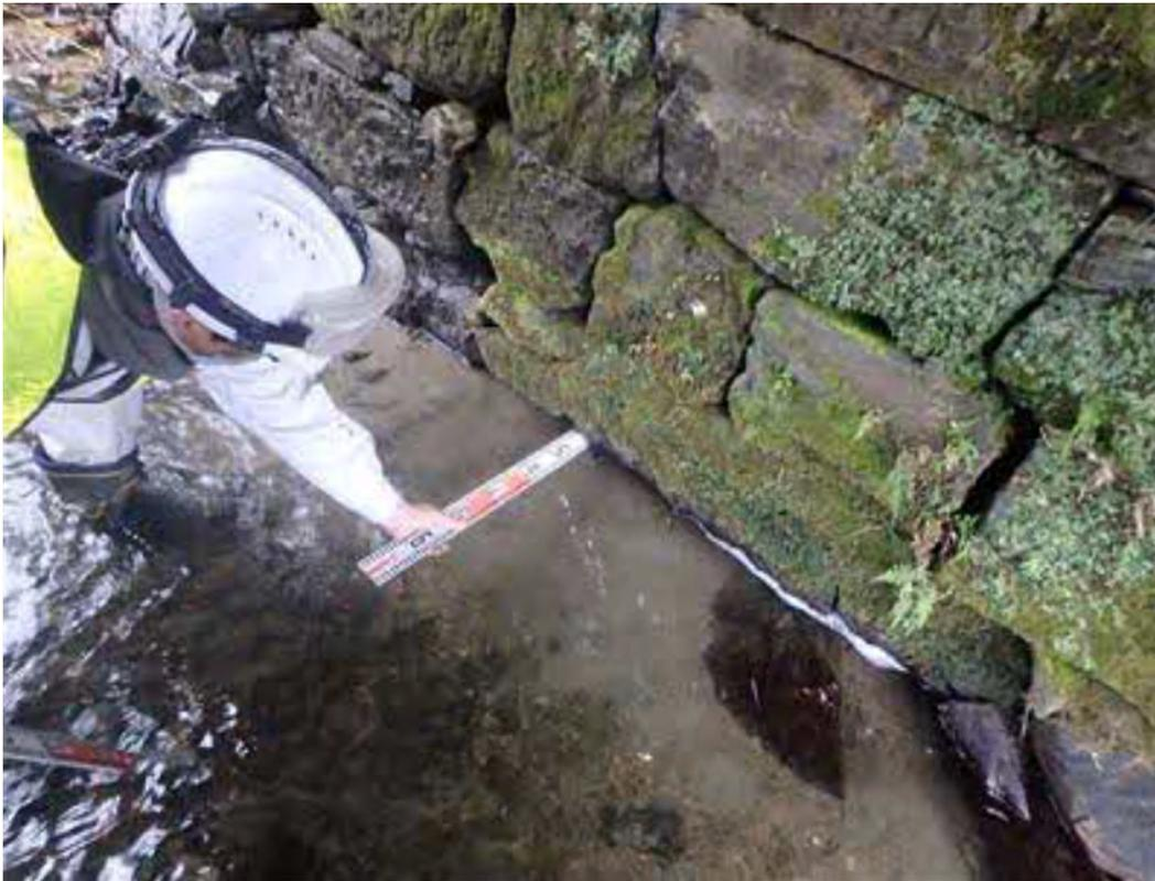
写真2.13-1 洗掘の計測状況①
