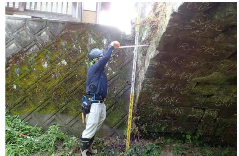
写真2.36-2 はらみ出しの計測状況の事例②
