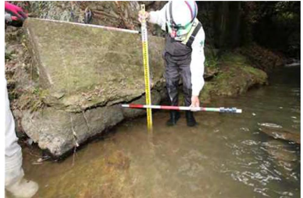
写真2.14-2 洗掘の計測状況②
