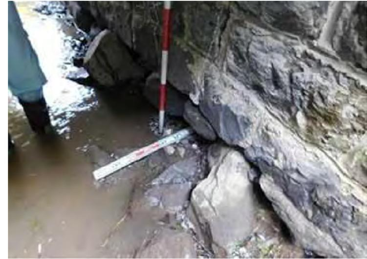
写真2.8-2 橋台の洗掘の計測事例
