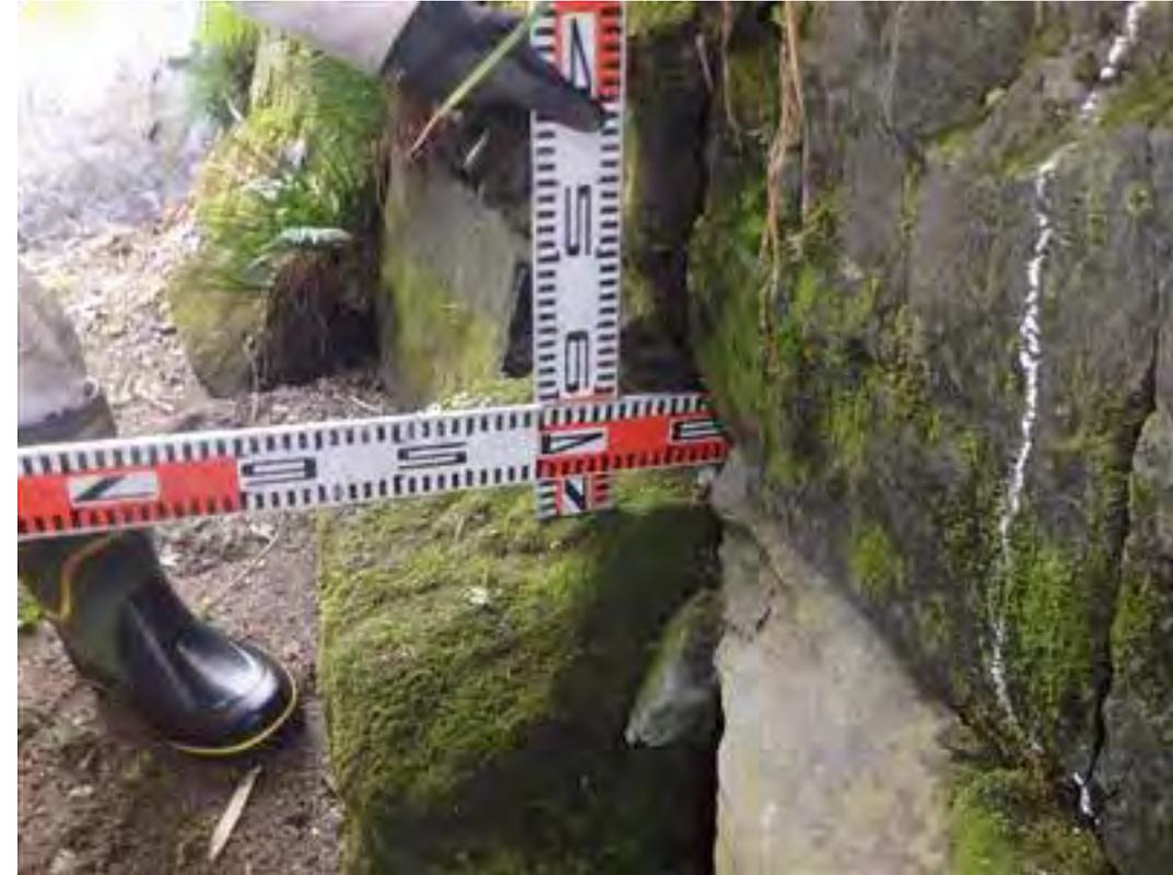
写真2.13-2 洗掘の計測状況②
