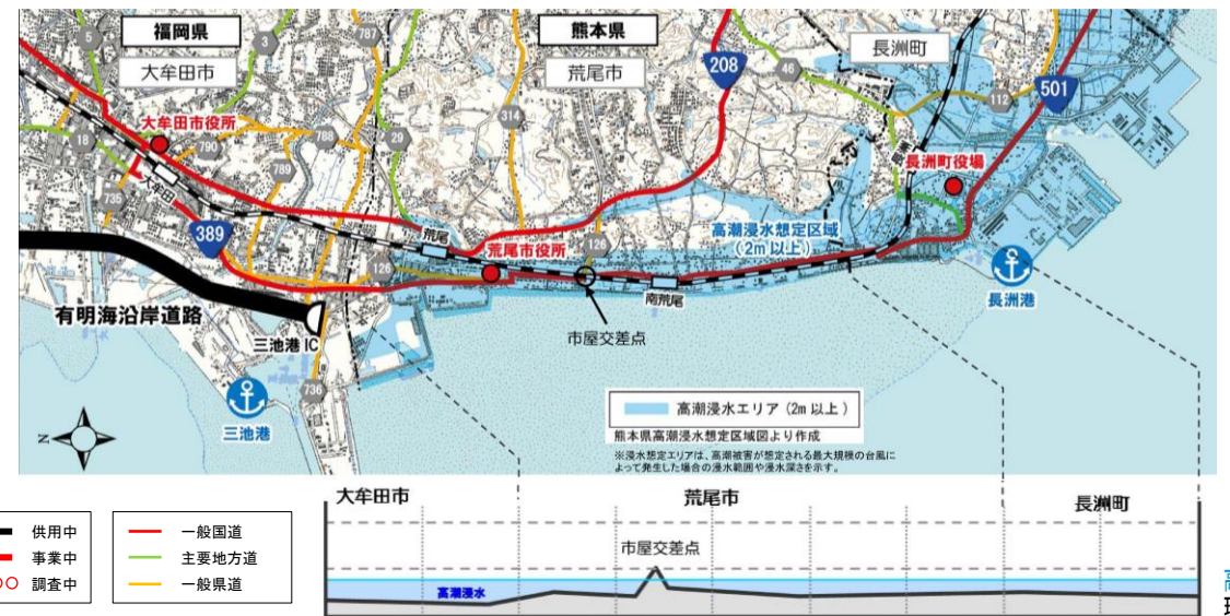
図7 国道389号の現道高と高潮浸水想定高さの関係
