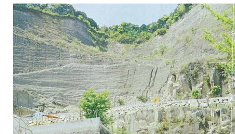
資料：岩石・岩盤図鑑 水分を含むと強度が落ちるシルス台地
