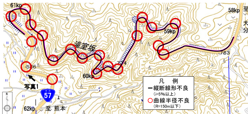
線形不良箇所
