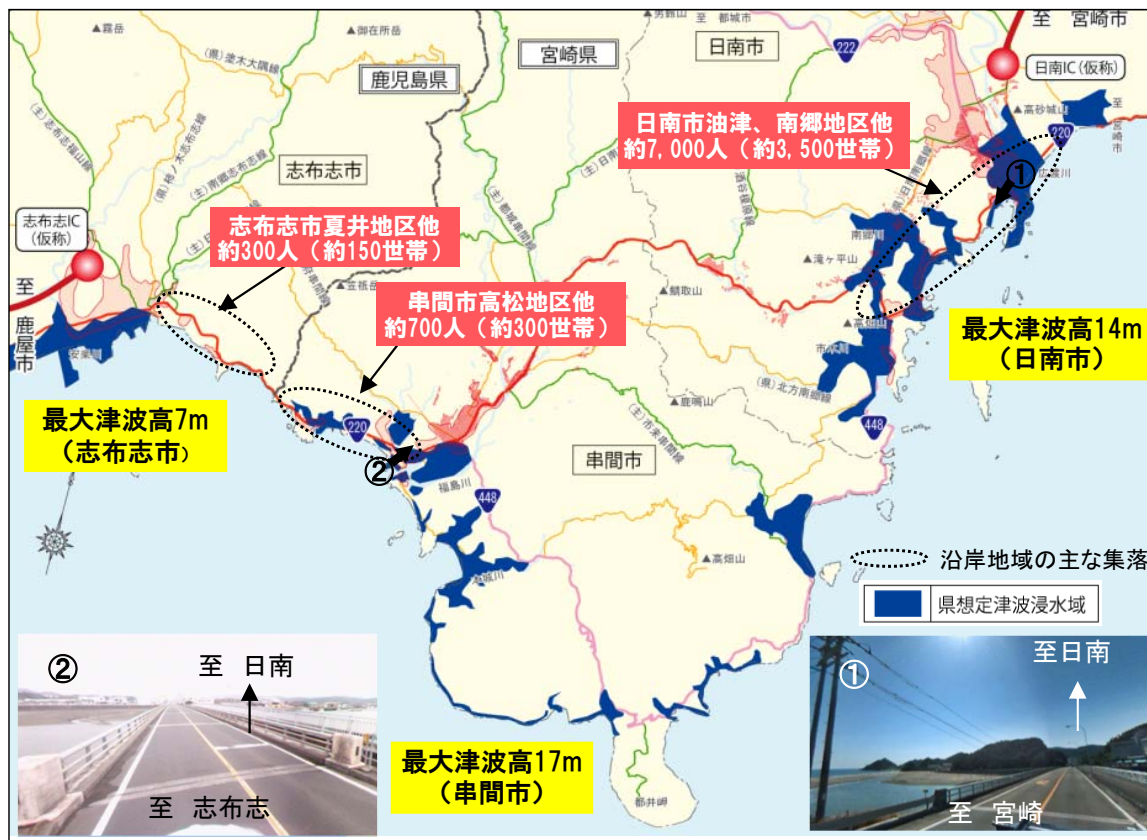
▼巨大地震による津波浸水想定範囲
