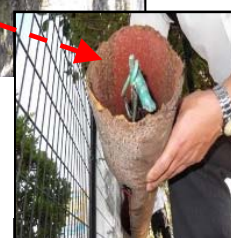
外灯ポールの根本の腐食 【台風時の強風で転倒外灯 倒による危害のおそれ】
