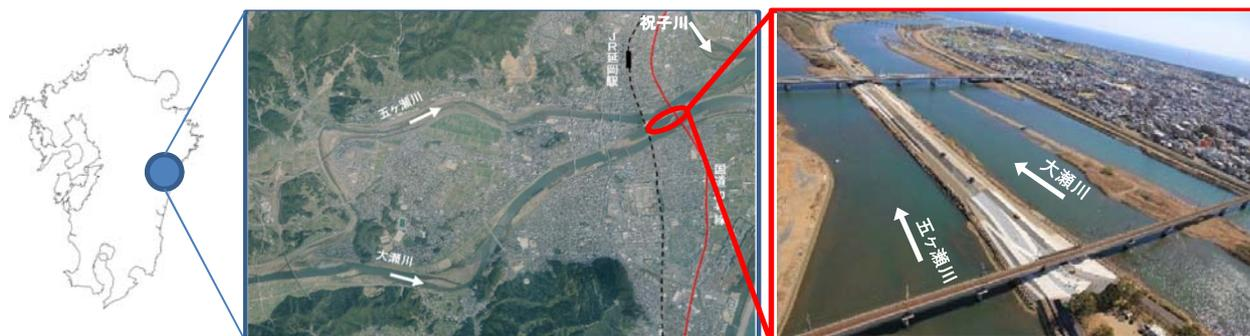
平成17年9月、台風17号による大洪水により大瀬川の洪水が五ヶ瀬川の洪水を堰き止めたため上流部にて越水しました。このため隔流堤を設置し、各々の洪水をスムーズに河口に流し、上流部の越水をなくしました。
