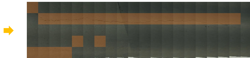
タイルを結合し、ひび割れ面積を可視化
