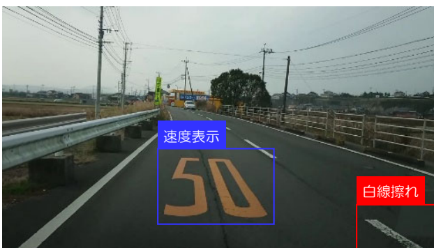
画像・動画から道路上の構造物や損傷を検出
