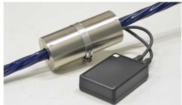
▲ケーブルの張力を計測
