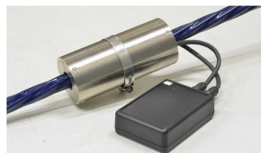
▲ケーブルの張力を計測
