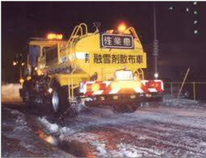
凍結防止剤を散布し、凍結を防ぐ
