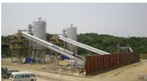
▲CSG製造設備(他ダム事例)
