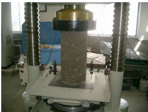
▲大型供試体試験 強度試験
