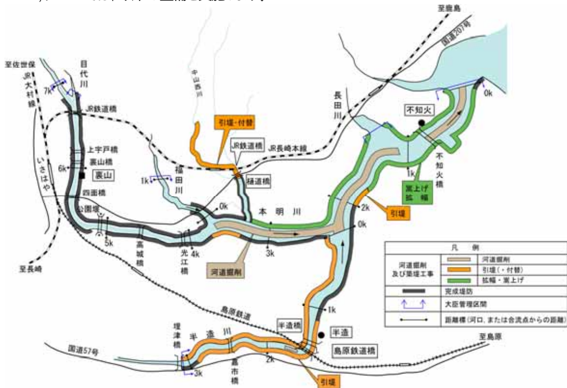
図4 - 2 - 3 河道掘削及び築堤工事の場所
