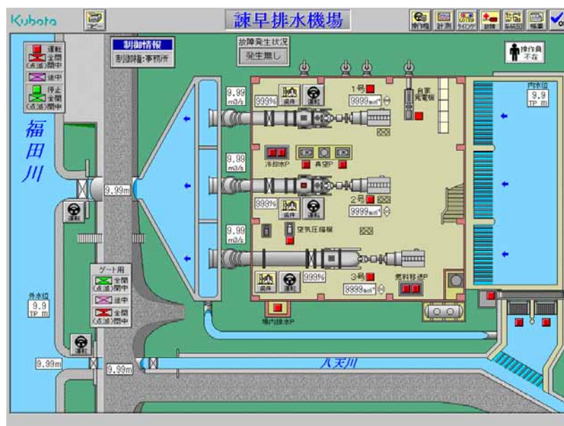
図4 - 3 - 6 ポンプ場遠隔操作(パソコン画面)
