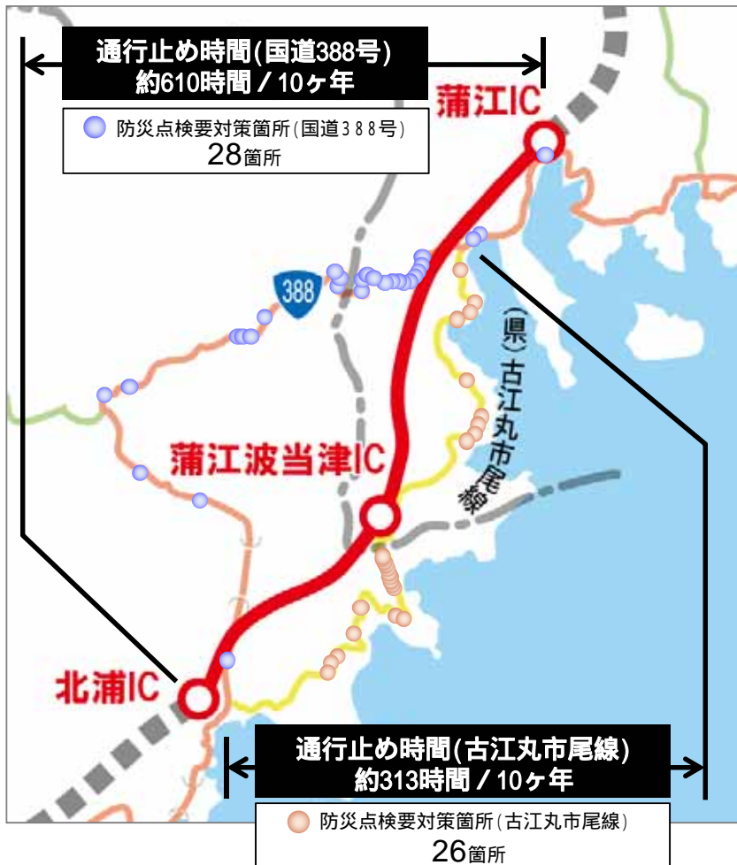
防災点検要対策箇所と過去10年(H14-23年)の通行止め履歴
