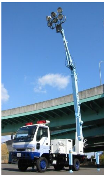
写真 5.3.9 夜間作業用の照明車
