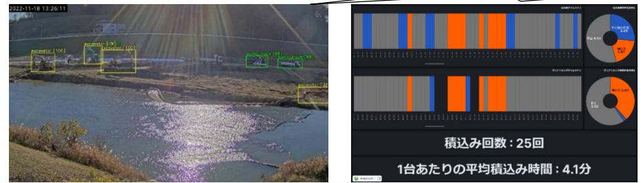
AIカメラによるダンプのリアルタイム入退管理 掘削重機の作業を可視化し、資機材の予実管理
