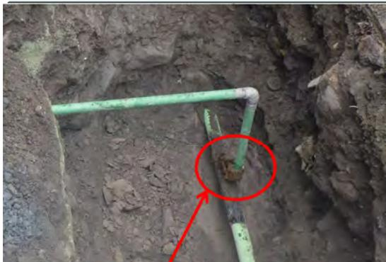
取出し部（亜鉛メッキ継手、防食なし）腐食漏れ
