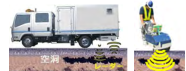
路面下空洞調査
