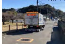
(空洞探査車による調査)
