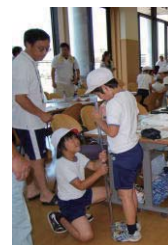
1mの透視度計に川の水を入れて、上から覗きこみ底の印がはっきり見える高さを記録します
