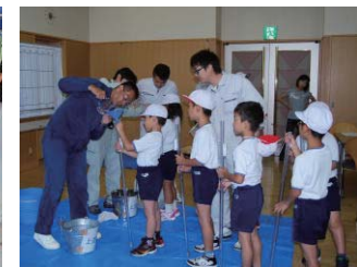
1mの透視度計に川の水を入れて、上から覗きこみ底の印がはっきり見える高さを記録します
