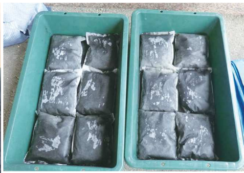
ため池に沈めた袋詰めの竹炭
