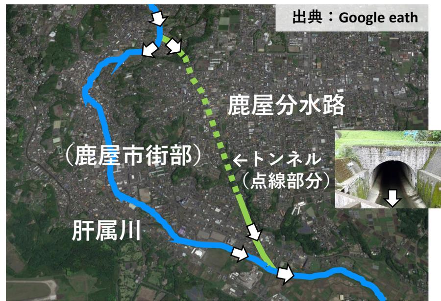
肝属川の洪水を分けて流すトンネル
