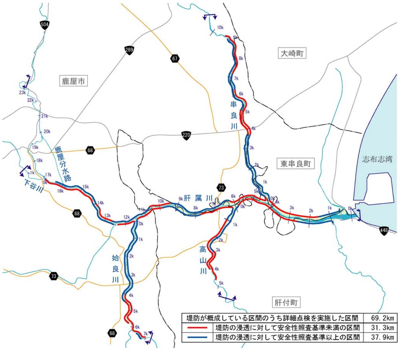
図 2.1.2 堤防詳細点検結果図
