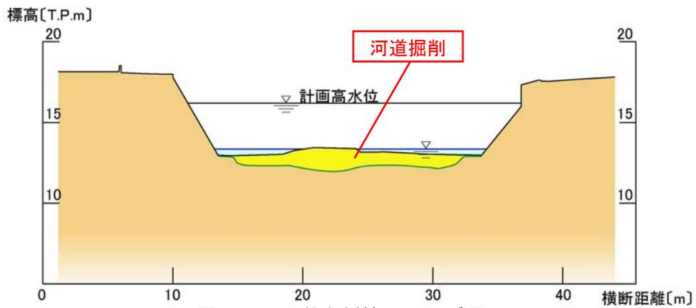
図 4.2.7 洪水対策イメージ図
