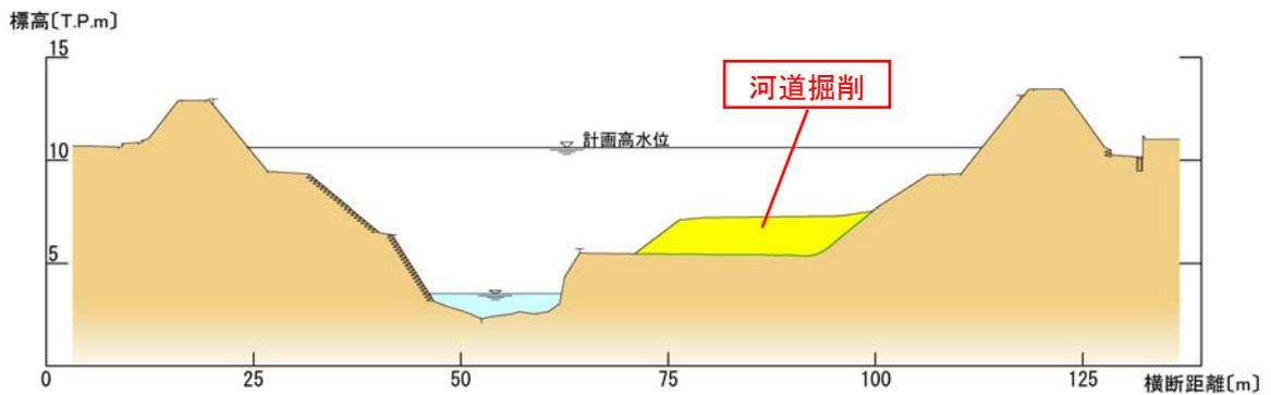
図 4.2.16 洪水対策イメージ図
