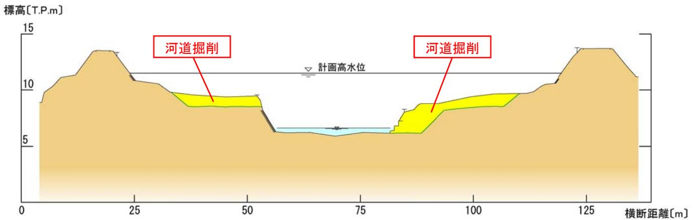
図 4.2.12 洪水対策イメージ図
