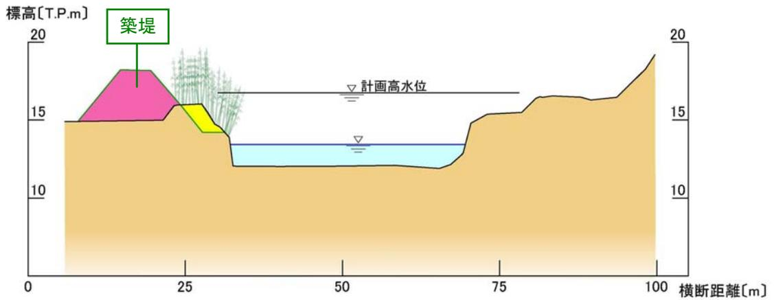
図 4.2.14 洪水対策イメージ図
