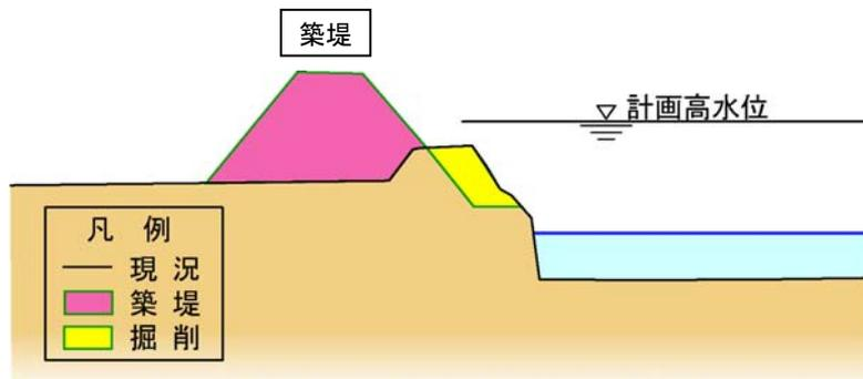
図 4.2.2 築堤のイメージ図
