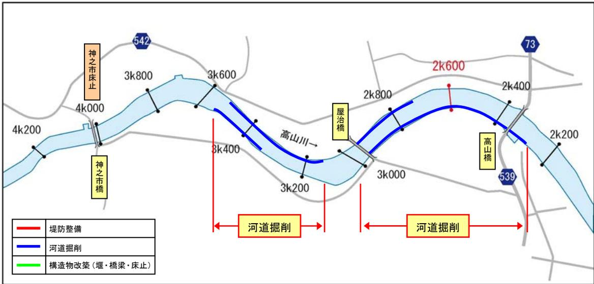
図 4.2.15 洪水対策箇所位置図
