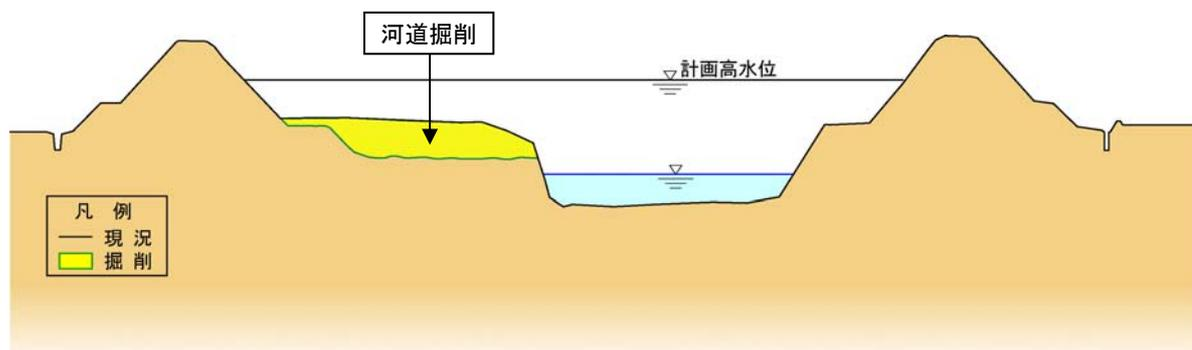
図 4.2.1 河道掘削のイメージ図
