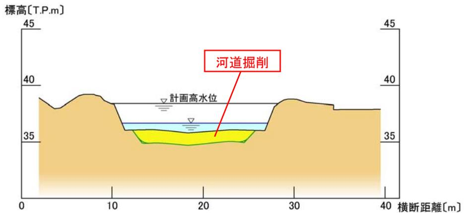
図 4.2.10 洪水対策イメージ図
