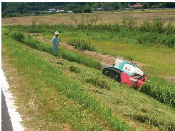
写真 2.1.5 大型遠隔操縦式草刈車による
