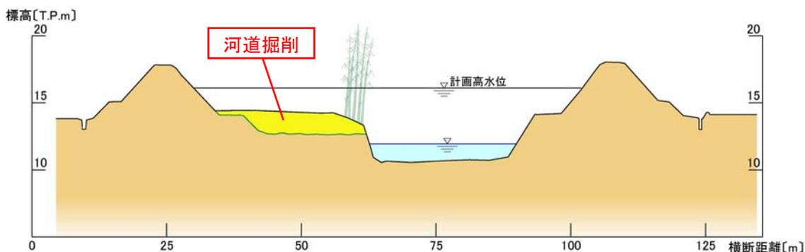
図 4.2.18 洪水対策イメージ図
