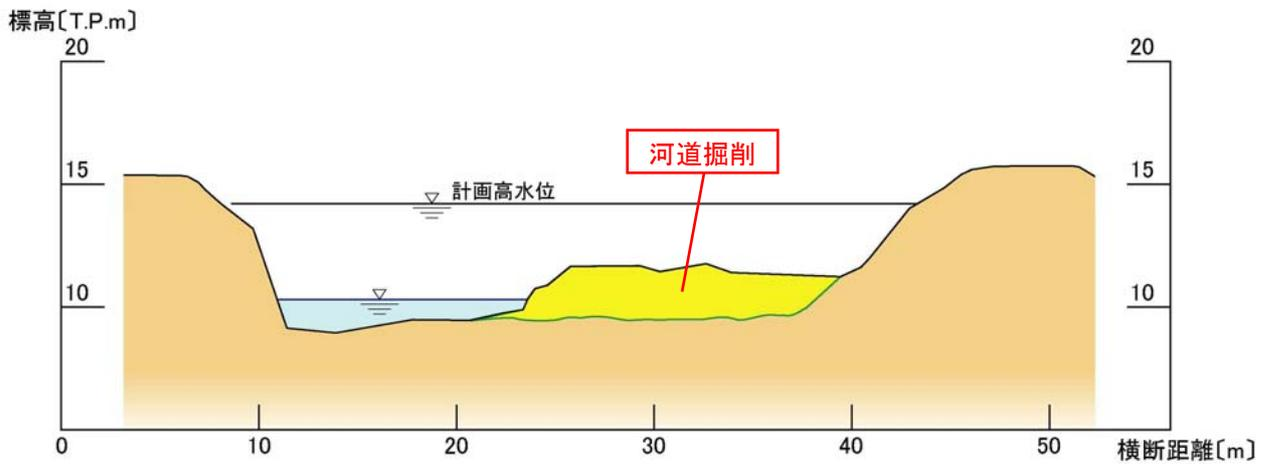
図 4.2.5 洪水対策イメージ図
