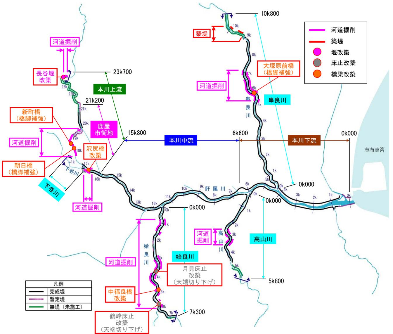
図 4.2.3 洪水対策箇所位置図
