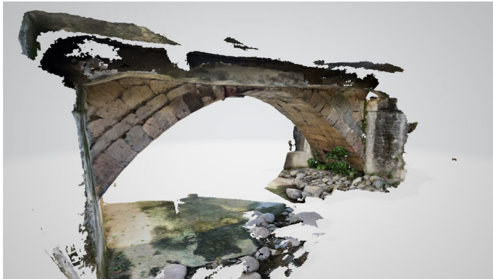
図 4-4 スマートフォンの三次元形状を計測するアプリを用いて三次元データを取得した事例
