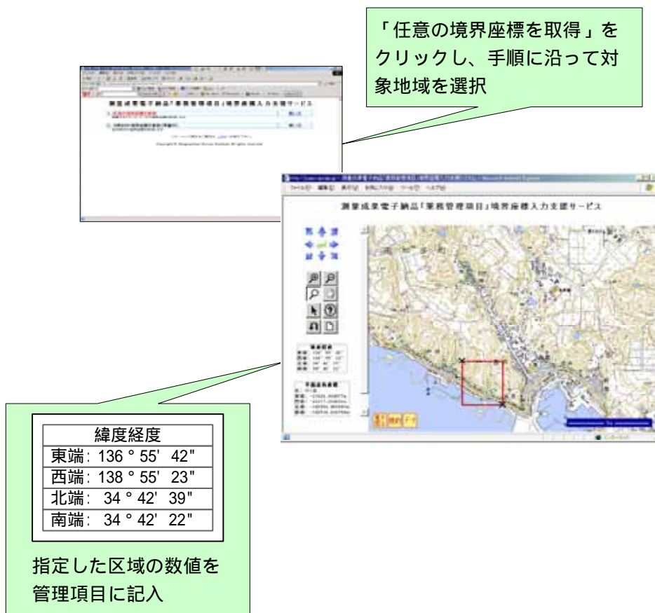
図 6-5 測量成果電子納品「業務管理項目」境界座標入力支援サービス
