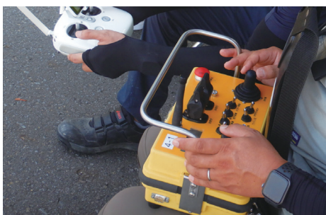
ドローンの映像を見ながらコントローラで遠隔操作
