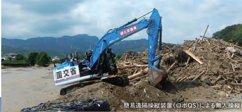
簡易遠隔操縦装置(ロボQS)による無人操縦
