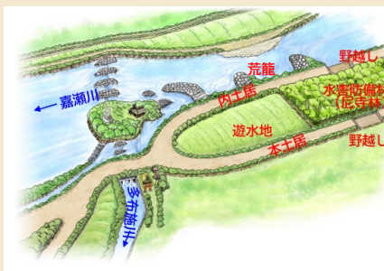
成富兵庫茂安により築かれた治水施設（野越し、荒籠など）
