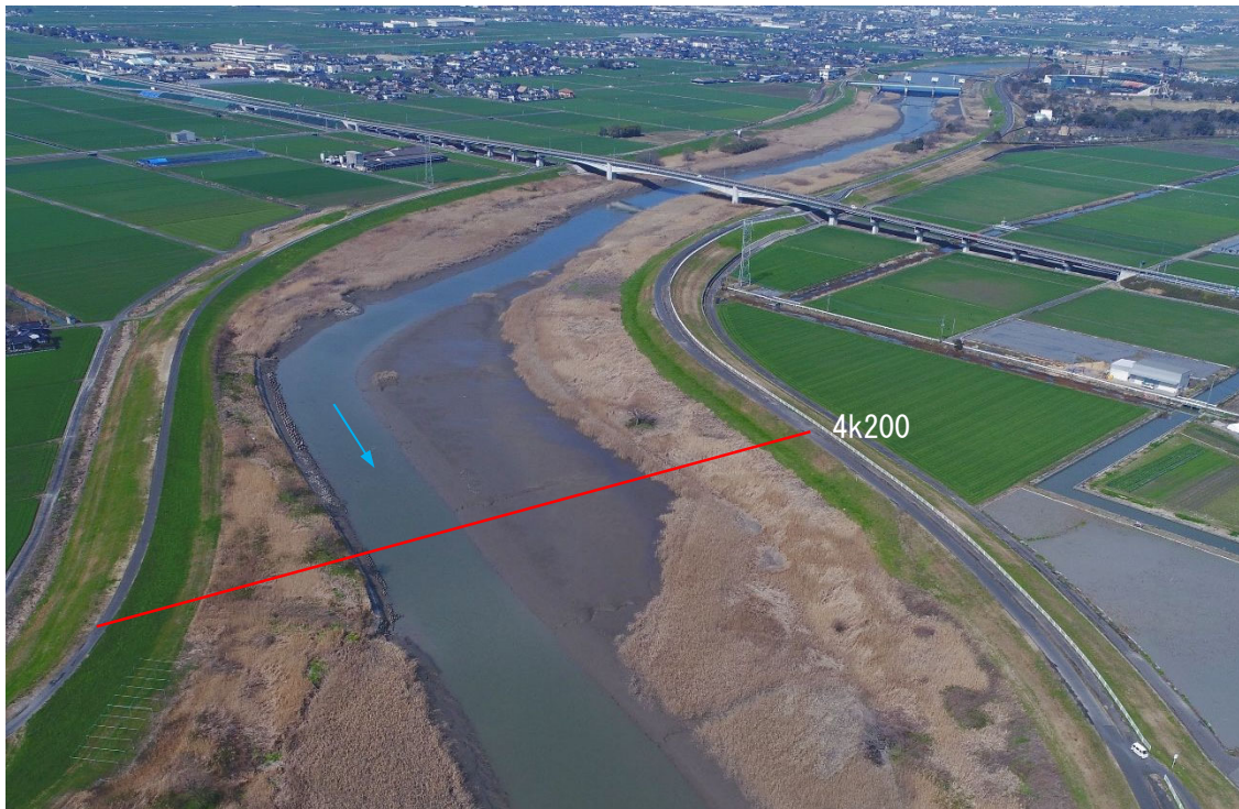
写真 2.1.8 ガタ土の堆積状況（嘉瀬川 4k200 付近：令和 2 年（2020 年）撮影）
