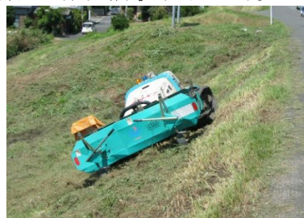
写真 4.3.2 遠隔操作による堤防除草作業
