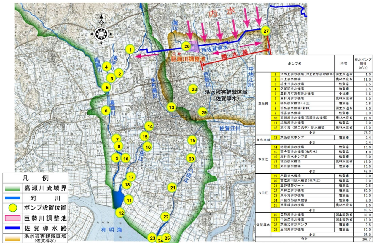
図 2.1.6 排水ポンプ設置箇所位置図
