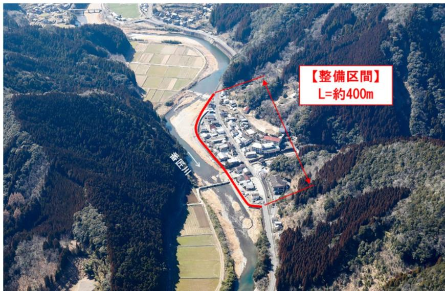
番匠川上流の波寄地区は、堤防高不足により平成17年9月の台風14号の出水では床下浸水6戸の被害が生じました。
