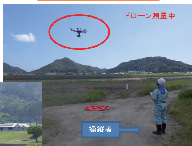
ドローンを使用した3次元測量
