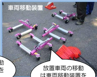
放置車両の移動は車両移動装置を使用します。
