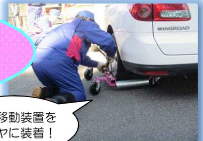
車両移動装置をタイヤに装着！
