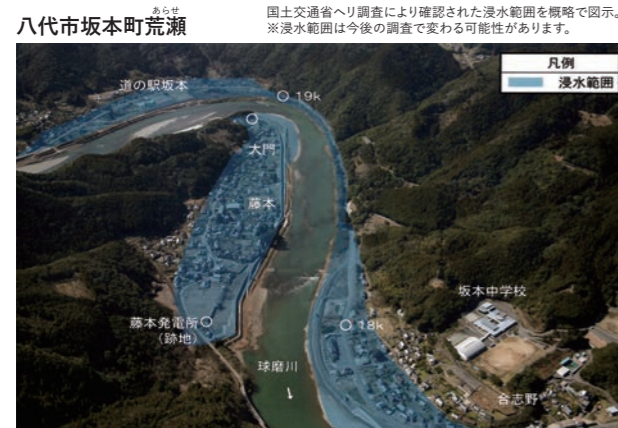
図7 八代市坂本町荒瀬地区の浸水状況
