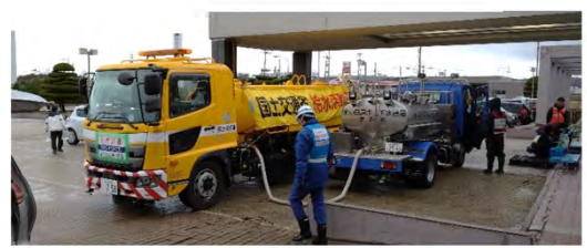
給水機能付散水車(給水支援)
