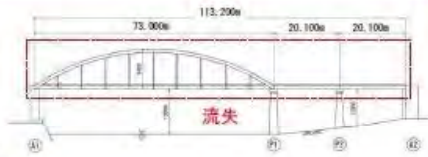
被災後の状況(上部正流失状況 A1~A2間)
