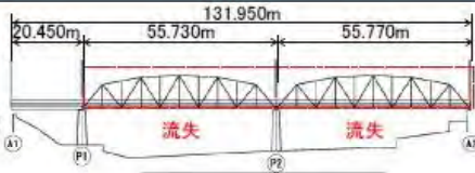
被災後の状況(上部工流失状況 P1~A2間)
