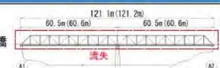
被災後の状況(上部工流失状況 A1~A2間)
