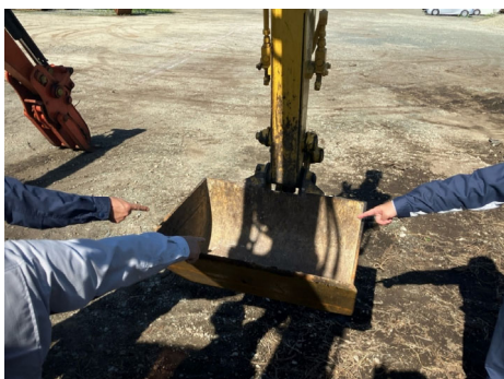
切り替え時バケット確認状況
