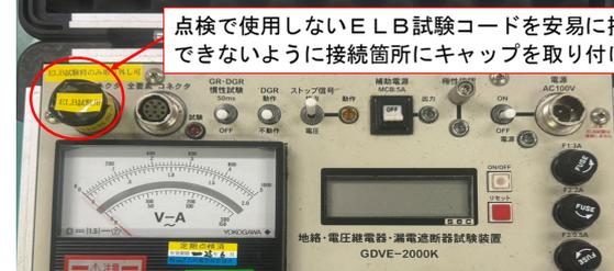
電源コードとELB試験コードを同時に測定器に接続できないように結束した
