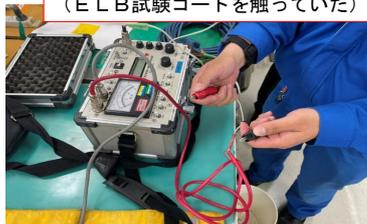
測定器主電源OFF状態でもELB試験コードに電気が流れる
