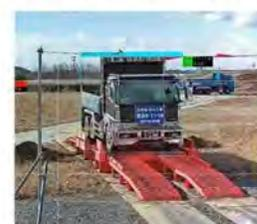
AIカメラによるダンプのリアルタイム入退管理
