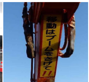
バックホウアームにステッカーを張り、注意喚起する
