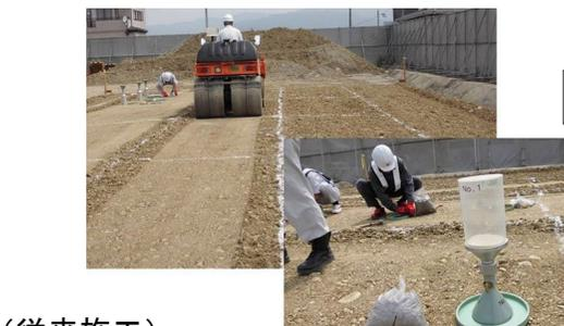
(従来施工) 砂置換による密度管理 (部分的な管理)
