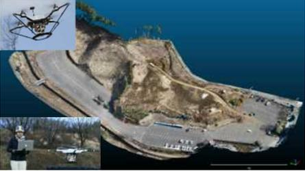
ドローン等による写真測量等により、短時間で面的(高密度)な3次元測量を実施。
