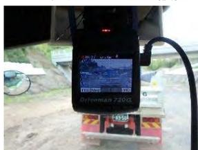
ダンプトラック全台数にドライブレコーダーを確実に取り付けたか元請が確認し、運転手の安全意識を高める。
