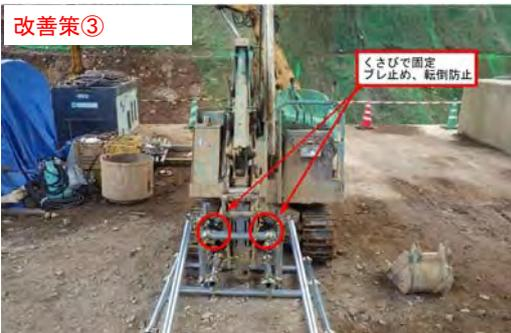
ブレード交換用架台を作り、坑外でアタッチメント交換する。
