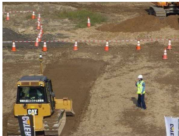
MCブルドーザによる 整地体験
