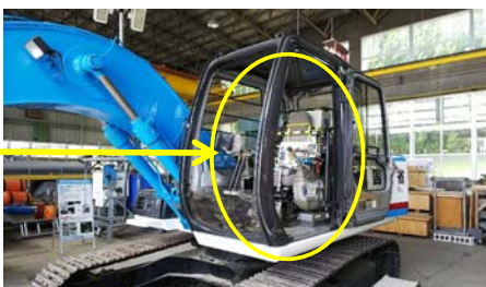
ロボQSの設置状況
