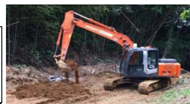
ロボQSによる地滑り災害対応（大分県豊後大野市）
