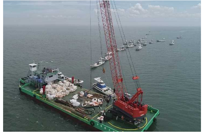
クレーン付台船による漂流物の連携回収 (一般社団法人 日本埋立浚渫協会 九州支部)
