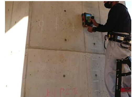
※) 橋脚RC巻立て工とは、既設柱の外周部に鉄筋コンクリートで巻立て補強を行って地震時の所要耐力を確保する工法。
