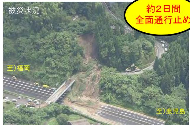
切土のり面崩落 約9,000m<sup>3</sup>
