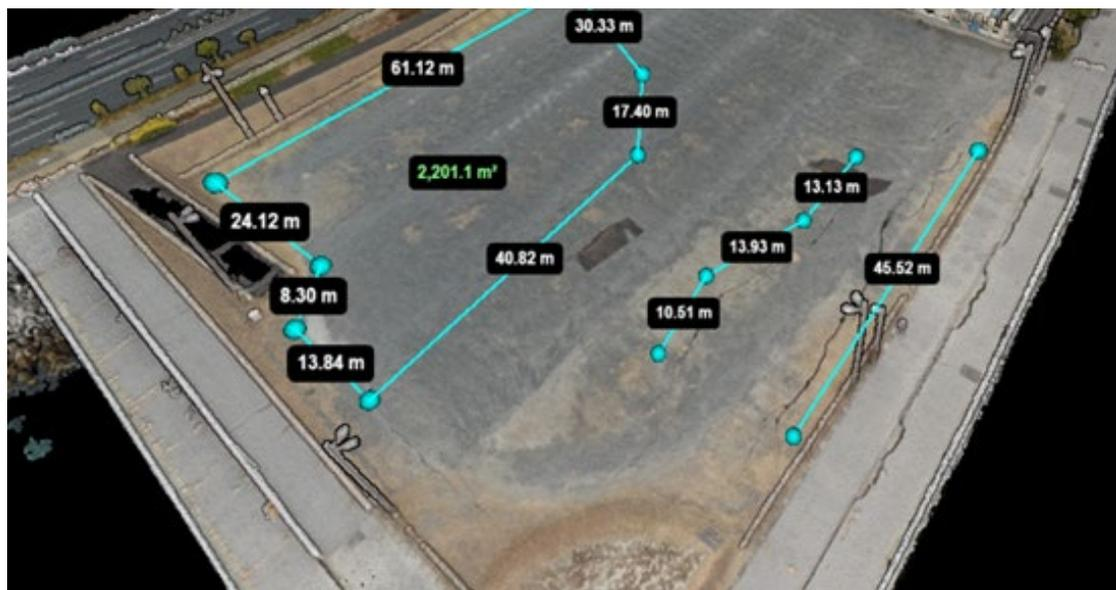
クラウドで共有した3Dモデル。マウスでクリックするだけで、簡単に面積や延長の確認が可能。
