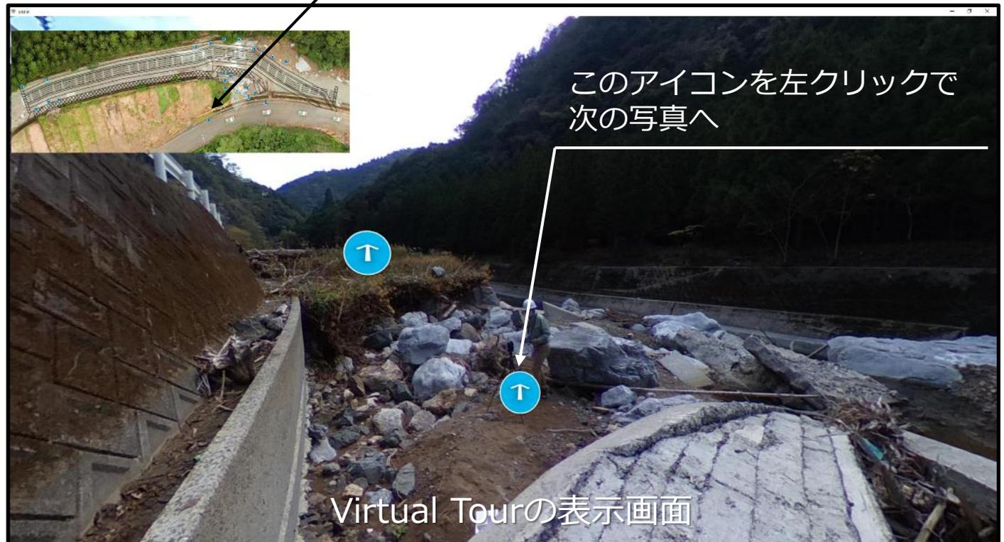
○点群クラウドを用いることでデータ処理を自動化、短期間かつ低価格で3Dモデルの構築が可能となった。また、そのままインターネットのブラウザで共有できるためソフトウェアのインストール、データのダウンロードが不要で、安価なPCでもストレスなく巨大なデータを取り扱うことができる。
