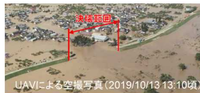
図-2 越水による決壊(千曲川)
