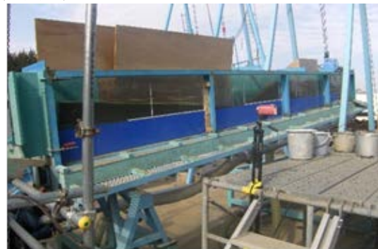
写真-3 堆砂勾配検証実験水路
