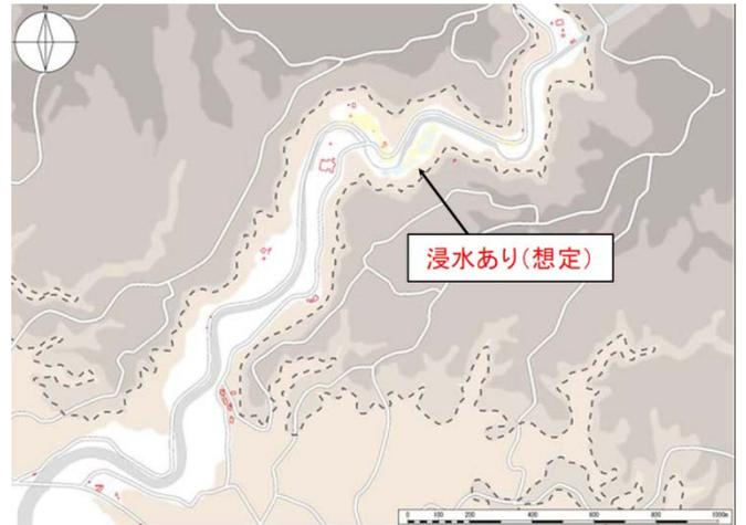
図-15 ダムあり・なしでの河川水位と浸水エリアの表示例
