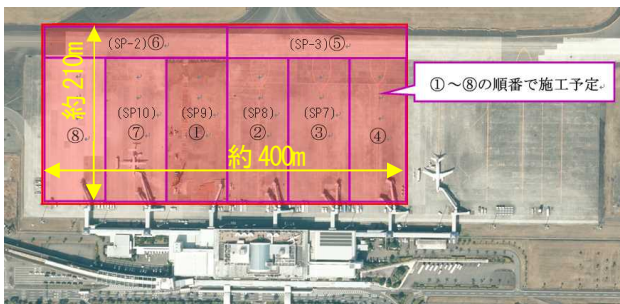
図-3 液状化対策箇所
